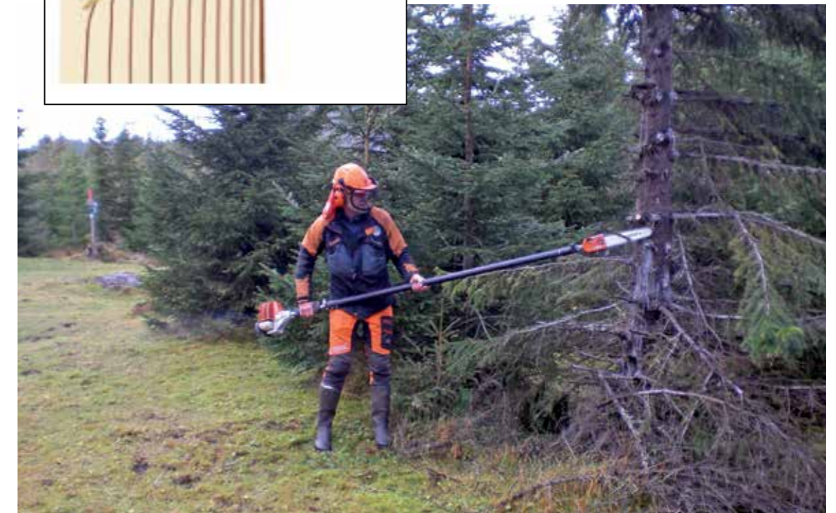
GRENSAGING: En kjederyddesag sager raskt vekk uønskete greiner. Vær forsiktig slik at stammen ikke skades.
